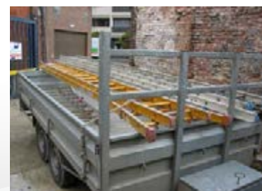
Figuur 19: Bij het transport moeten ladders degelijk worden vastgemaakt
