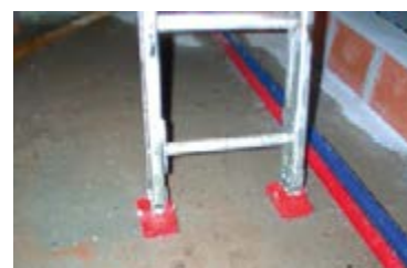
Figuur 13: Ladderschoenen geven een ladder meer stabiliteit
