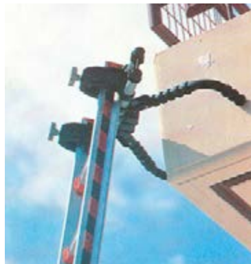
Figuur 11: Hulpstuk om een ladder op te stellen tegen een hoek van een gebouw
